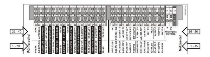
Der Anschluss der Fühler, Pumpen und weiteren Komponenten erfolgt gemäß dem Anschlussschema im Gehäusedecke des Wandaufbaugehäuses.
